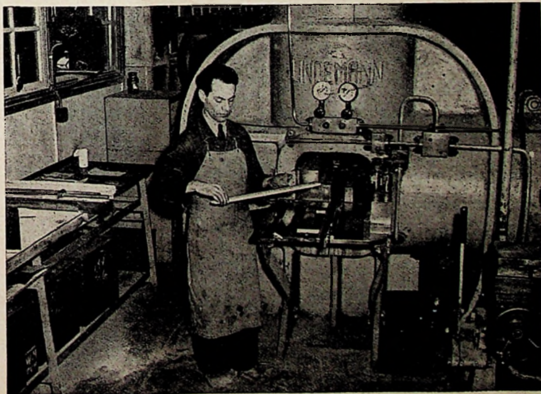
Het persen van Wolframpoeder tot staven in de hydraulische pers.
